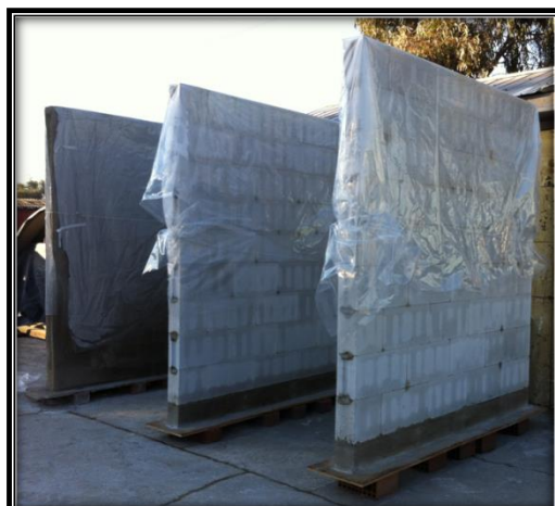
Figura 3.1. Ubicación de las probetas antes del ensayo. Ladrillo "King Kong" (izquierda), Placa P-12 (centro), Placa P-14 (derecha).
